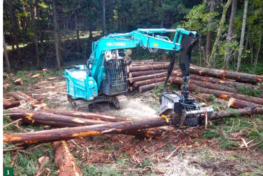
①五泉市水戸野地区の利用間伐と主伐再造林の現場。伐倒した木をプロセッサで造材している
